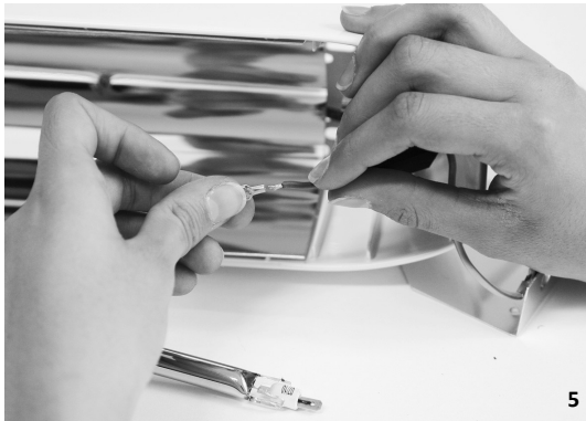
5. SE USURATE, INFILARE LE CAPSULE AL POSTO DI QUELLE RIMOSSE, SPELARE I CAVI PER 5-6 mm, INFILARE I NUOVI FASTON E FISSARLI SUL CAVO. NON TOCCARE IL BULBO A MANI NUDE.
