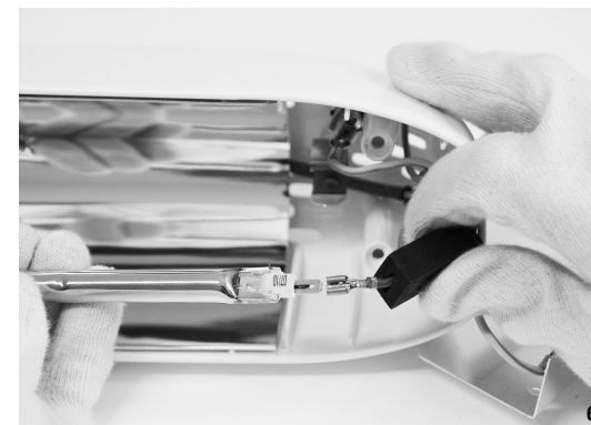
6. CONNECTER LES CONNECTEURS MALES DE LA NOUVELLE AMPOULE A CEUX DES DEUX CABLES, LES RECOUVRIR AVEC LES CAPSULES ET REPOSITIONNER L'AMPOULE DANS LE SIEGE DES DEUX RESSORTS. RECOMPOSER L'APPAREIL EN SUIVANT LA PROCEDURE A L'ENVERS.
