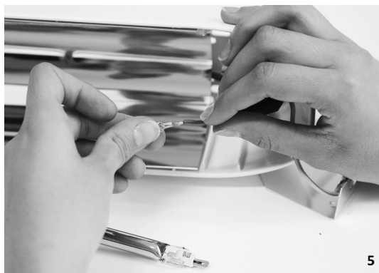
5. SI USAGEES, INTRODUIRE LES CAPSULES A LA PLACE DE CELLES QUI ONT ETE ENLEVEES, PELER LES CABLES POUR 5-6 mm, INTRODUIRE LES NOUVEAUX CONNECTEURS ET LES FIXER SUR LE CABLE. NE PAS TOUCHER L'AMPOULE LES MAINS NUES.
