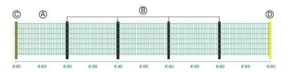
\*Um die Pforte richtig einbauen zu können, benötigst du eine Doppelstabmatte, die in zwei gleiche Teile geschnitten und links und rechts der Pforte eingebaut wird.
