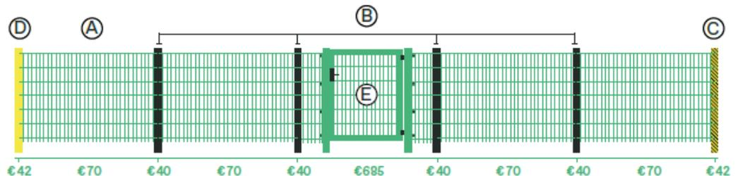
**i** \*Um die Pforte richtig einbauen zu können, benötigst du eine Doppelstabmatte, die in zwei gleiche Teile geschnitten und links und rechts der Pforte eingebaut wird.
