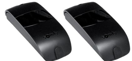
Befindet sich ein Hindernis im Lichte der Einfahrt, wird der Infrarotstrahl unterbrochen, das Tor stoppt und kehrt in die offene Position zurück.
