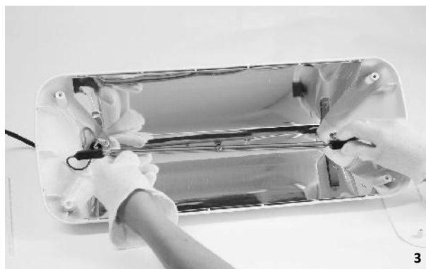
3. DIE LAMPE AUS DEN BEIDEN FEDERN NEHMEN.
