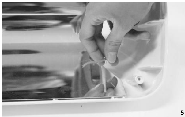
5. IBEI VERSCHLEISS NEUE DICHTUNGEN ANBRINGEN, DIE KABEL 5-6 mm ABISOLIEREN, DIE NEUEN FLACHSTECKER ANBRINGEN UND AM KABEL BEFESTIGEN. STREIFEN SIE DAS KABEL 5-6 MM. DIE NEUEN FLACHSTECKER ANBRINGEN UND AM KABEL BEFESTIGEN. DIE LAMPE NICHT MIT BLOSSEN HÄNDEN ANFASSEN.
