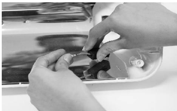
6. DIE FLACHSTECKER DER NEUEN LAMPE MIT JENEN DER BEIDEN KABEL VERBINDEN, DIE DICHTUNGEN ÜBERZIEHEN UND DIE LAMPE IN DEN SITZ DER BEIDEN FEDERN EINSETZEN.
