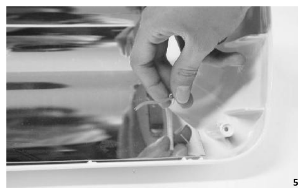
5. INTRODUCIR LAS CÁPSULAS ELASTOTÉRMICAS DE REPUESTO EN EL LUGAR DE LAS QUITADAS, PELAR LOS CABLES 5/6 mm, COLOCAR LOS NUEVOS FASTON DE REPUESTO Y APLASTARLOS SOBRE LA PARTE PELADA DE LOS CABLES. PRESTAR ATENCIÓN A NO TOCAR LA BOMBILLA CON LAS MANOS DESNUDAS.
