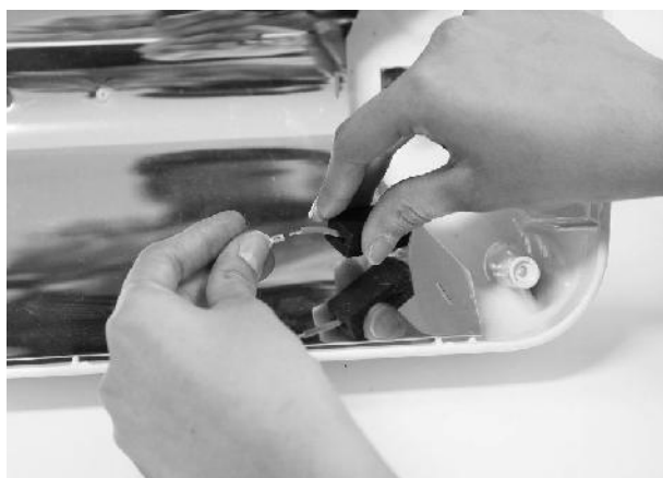
6. COLLEGARE I FASTON MASCHI DEL NUOVO BULBO A QUELLI DEI DUE CAVI, RIVESTIRLI CON LE CAPSULE ELASTOTERMICHE E RIPOSIZIONARE IL BULBO NELLA SEDE DELLE MOLLETTE
