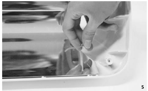
5. ENFILER LES PROTECTIONS THERMO-ÉLASTIQUES DE RECHANGE À LA PLACE DE CELLES QUI ONT ÉTÉ RETIRÉES, DÉNUDER LES FILS SUR 5/6 MM. ENFILER LES NOUVELLES COSSES (FASTON) DE RECHANGE ET LES SERTIR SUR LA PARTIE DÉNUDÉE DES FILS. NE PAS TOUCHER L'AMPOULE À MAINS NUES.
