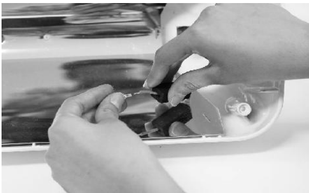
6. RACCORDER LES COSSES (FASTON) MÂLES DU NOUVEAU TUBE À CELLES DES DEUX FILS D'ALIMENTATION, LES RECOUVRIR AVEC LES PROTECTIONS ET REMETTRE LE TUBE DANS SON LOGEMENT DANS LES CLIPS.
